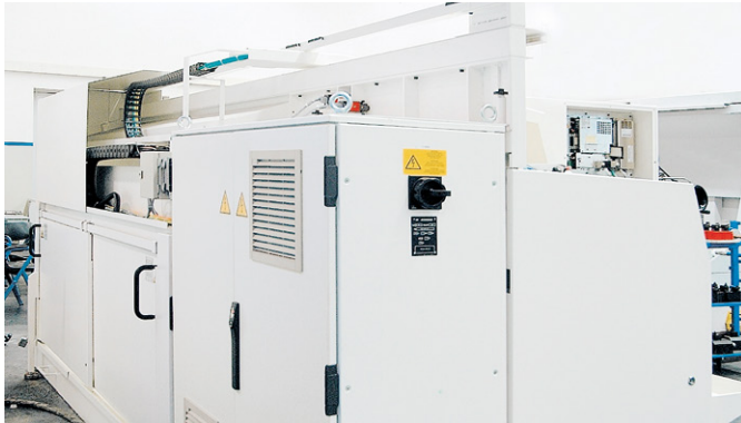
Zur Erhöhung der Servicefreundlichkeit befindet sich die gesamte Energiezuführung außerhalb des Arbeitsraums
