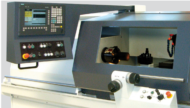
Schwenkbares Bedienpult. Nicht mitfahrende Späneschutztüre
