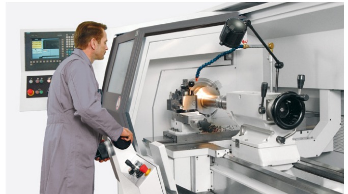
Optimaler Schutz des Bediener durch großflächige Späneschutztür. Alle Bedienelemente außerhalb des Arbeitsraums
