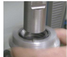
Es ist darauf zu achten, dass die 3 Stifte der Spülbüchse genau auf die eingebrachten Bohrungen passen.
