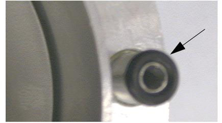
Gehäuse mit unterer Spülbüchse korrekt einsetzen!
