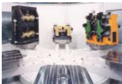
Bedienerarme Fertigung mit Paletten-Rundspeicher
