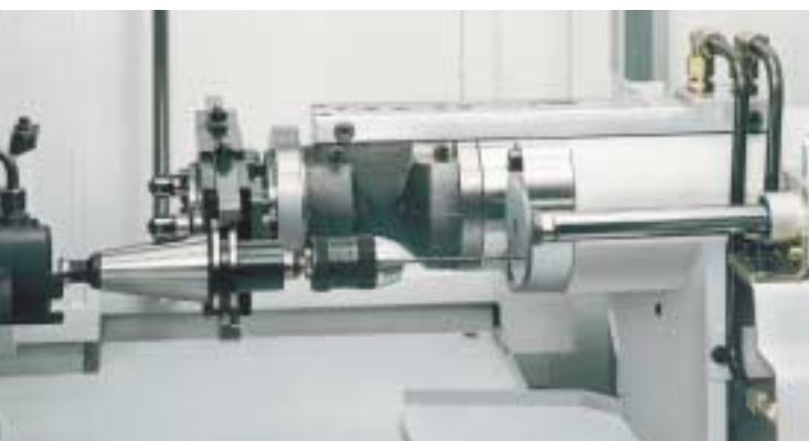
Direkte Werkzeugbruchkontrolle am Bruchindikator
