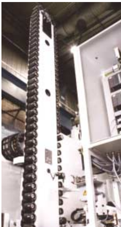
Spindelparallele Anordnung der Werkzeuge im Kettenmagazin sichert Span-zu-Spanzeit 3,5 s
