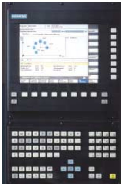
Übersichtlicher Hauptbedienstand mit CNC-Bedienblende
