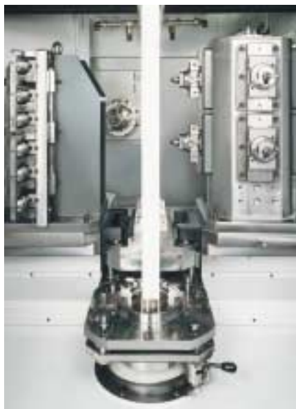
Palettenwechsel in \leq 8 s (CWK 400 D) und \leq 9 s (CWK 500 D) mit hydraulischem Drehwechsler
