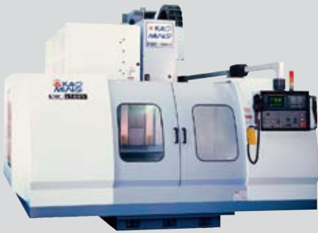
Vertikale Bearbeitungszentren mit X-Verfahrweg 1100 und 1500 mm, mit großem Querverfahrweg bis 800 mm.
