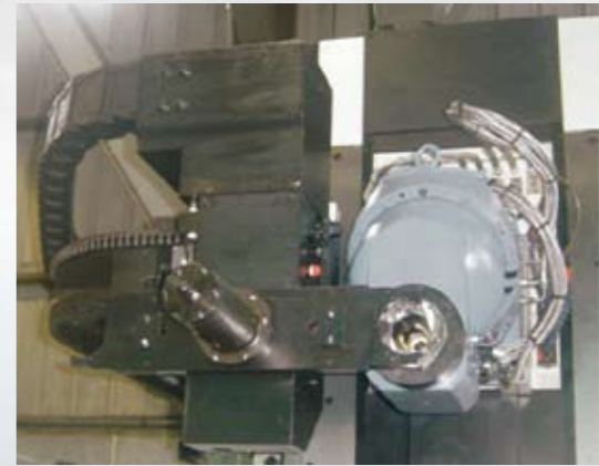
Horizontaler Werkzeugwechsel mit 32, 40 oder 60 Stationen, Schienen-Schwenkartyp.
