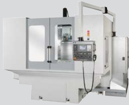
Starrbettfräsmaschinen mit X-Verfahrweg bis 8000 mm, komplexen Ausstattungsmöglichkeiten. Universalfräsköpfe, Werkzeugwechsler, Rundtische integriert oder als Vorsatz auch mit W-Achse.
