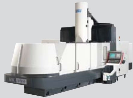
Portalfräsmaschinen zur 3-Achs-Bearbeitung mit Vertikalaus- gang bis 18000 min -1 , als Hochfrequenzspindel oder bis 7500 min -1 mit Getriebe lieferbar für schwere Zerspanung. X-Verfahrweg 2230 - 8230 mm Durchlass zwischen den Ständern bis 2800 mm.
