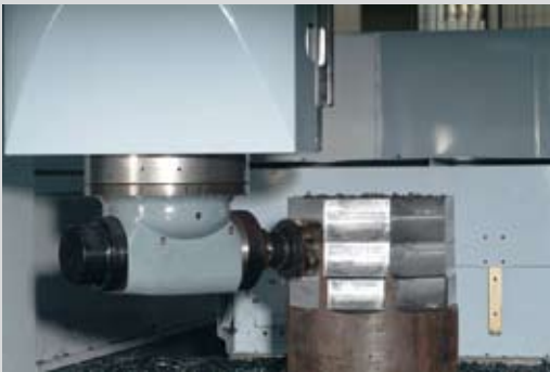
Portalfräsmaschinen zur 5 Seitenbearbeitung mit automatisch einwechselbaren Fräsköpfen und Standard Werkzeugwechs- lern. X-Verfahrweg 2000 bis 8000 mm Durchlass zwischen den Ständern bis 2800 mm.
