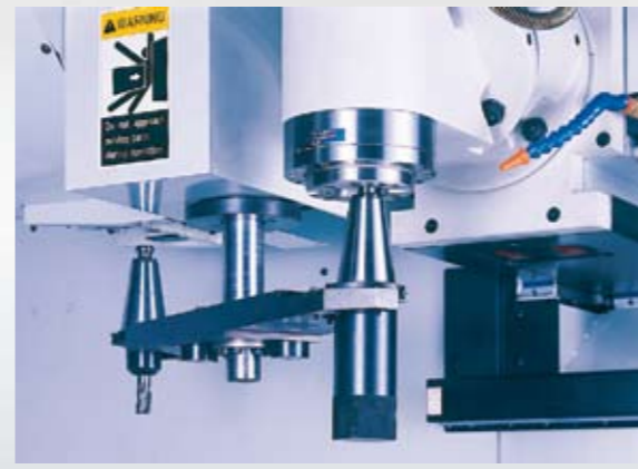
Vertikaler Werkzeugwechsel mit 24 Stationen, Schwenkartyp.
