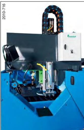
Installé sur l'**ALPHATOME®**, l'unité de perçage mécanique permet de combiner sur la même machine les opérations de perçage, marquage et découpe.
