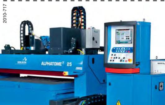
Le découpage plasma de haute qualité requiert de plus en plus de précision. L'**ALPHATOME<sup>®2</sup>** permet la coupe et le marquage par procédé plasma des aciers au carbone (non alliés ou faiblement alliés), des aciers inoxydables et des alliages légers, sur des tôles d'épaisseurs de 0,5 mm à 50 mm.
