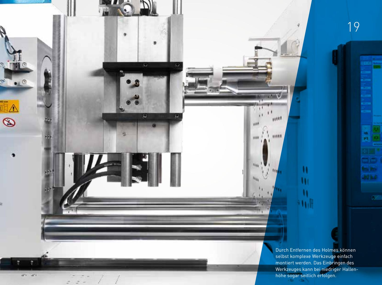
Durch Entfernen des Holmes können selbst komplexe Werkzeuge einfach montiert werden. Das Einbringen des Werkzeuges kann bei niedriger Hallenhöhe sogar seitlich erfolgen.
