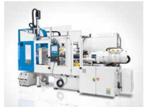
Linearroboter im Längsastrag: Teileablage auf dem Förderband innerhalb der Standardschutzeinhausung der Spritzgießmaschine.
