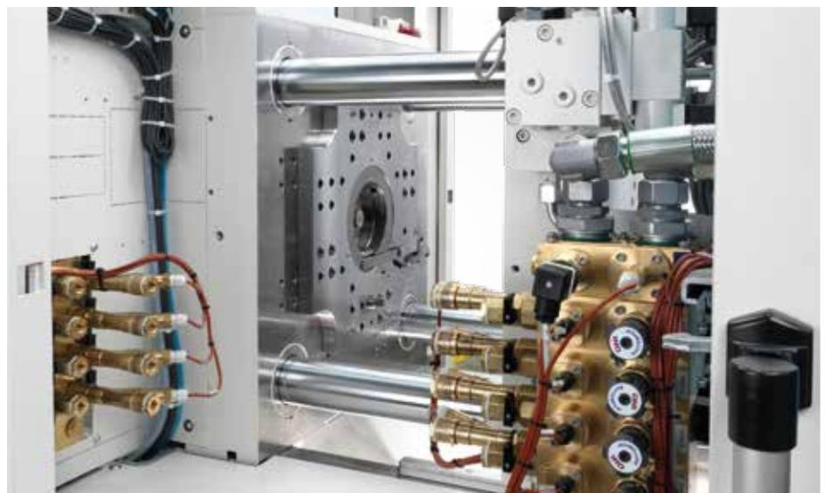
Geringerer Energiebedarf bei Temperiergeräten aufgrund der deutlich größeren Querschnitte der Zuleitungen.
