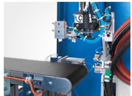
Kompakt integriertes Förderband innerhalb der Schutzeinhausung.
