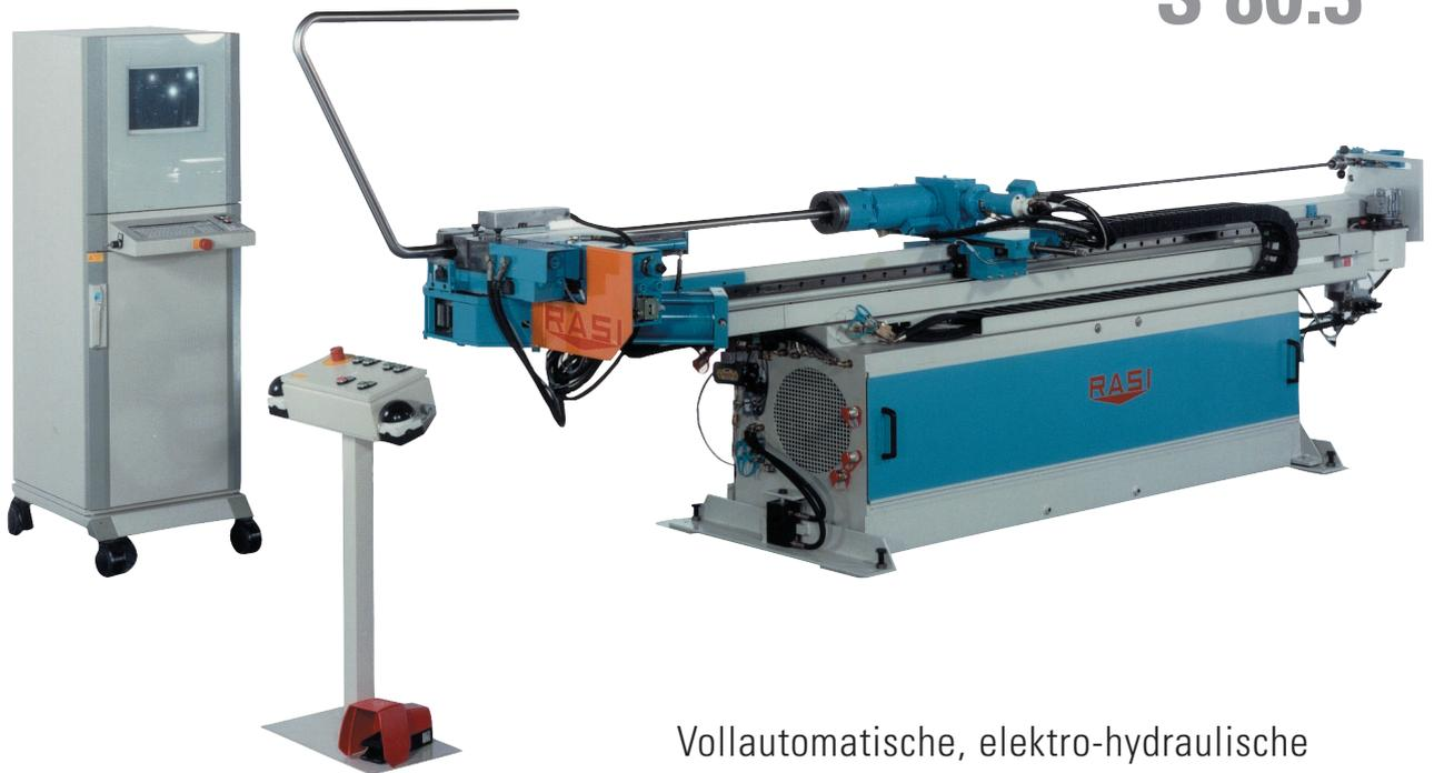
Vollautomatische, elektro-hydraulische Kaltrohrbiegemaschine RASI S 80.3 mit 3-Achsen-CNC-Microprozessorsteuerung zur einfachen und anschaulichen Eingabe der Biegedaten über Bildschirm
