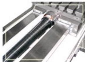
Gross dimensionierte Flachführungen für leistungsstarke Zerspanung
