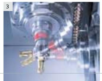
1| Bearbeitung mit B-Achse 2| Flüssigkeitsgekühlte Haupt- und Vorschubmotoren
