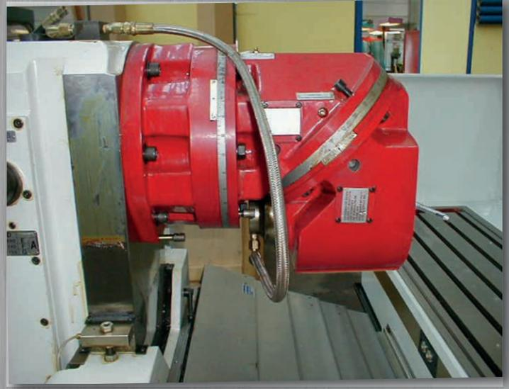
Die Wärme – und Geräuschentwicklung ist außerordentlich gering. Bei Demontage des Kopfes steht ein SK-50-Horizontalausgang zur Verfügung (Nicht bei Modell U-1000).
