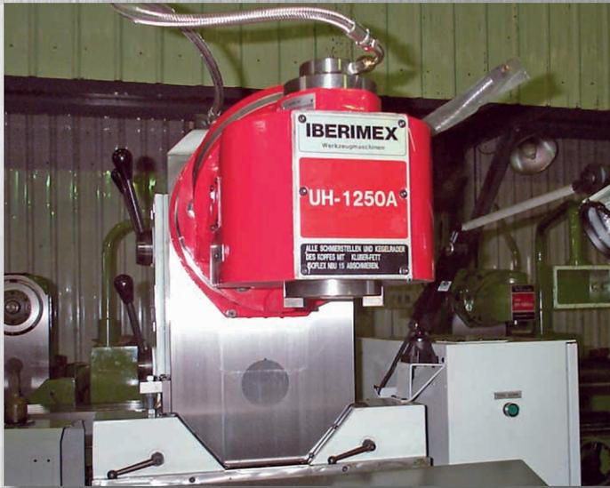
Der serienmäßige, in zwei Ebenen manuell schwenkbare Universalfräskopf erreicht jede beliebige Gradzahl zur X- und Y-Achse. Durch spiralverzahnte, gehärtete und geschliffene Kegelräder (System Klingenberg) wird das Zahnflankenspiel auf ein Minimum reduziert und ein verschleißarmer Lauf erzielt.
