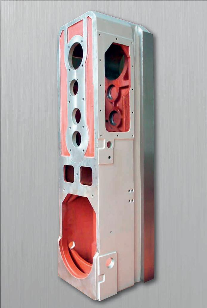
Sowohl der Maschinenunterbau als auch der Maschinenständer sind jeweils aus einem Stück gegossen und für höchste Stabilität stark verrippt.
