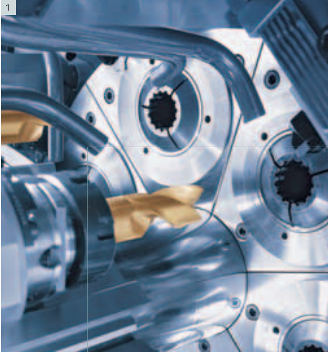
|1| Max. Drehzahlbereich bis 4.000 min -1 |2| CNC-Kreuzschlitten ermöglichen komplexe Bearbeitungen
