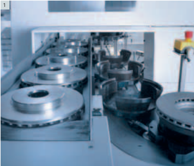
11| Doppelspuriges Be- und Entladen für mehr Flexibilität in der Automatisierung und einfachste Integration in Fertigungslinien 12| Y-Achse für komplexe Bearbeitungen 13| Verschleißfreier Linearantrieb in der X-Achse
