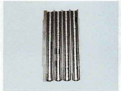
\phi 16 \times 150\text{mm} (SCM420)
